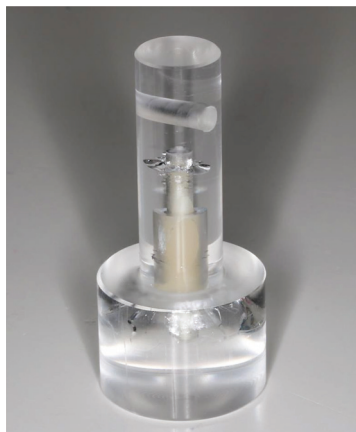
図3 ファイバーポストと支台築造用レジンの接着試験片
