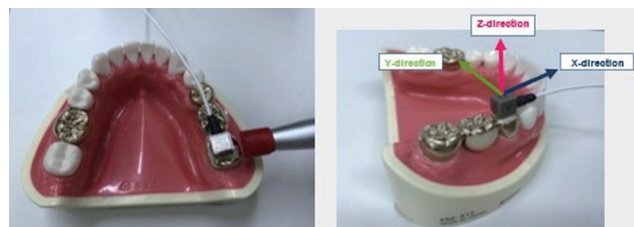
図3 実験用下顎模型での振動刺激の方向。
