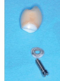
図 15 機能 6 年 7 か月後のダイレクト上部構造の破折
